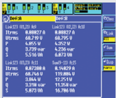
星型连接绕组的计算值 (接线：3+1，UΔ I*→ U* I*)
