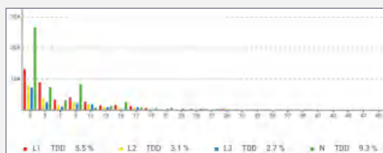
每个电流模块的所有 4 个电流的谐波/间谐波分析，也可作为 10 分钟平均值提供
